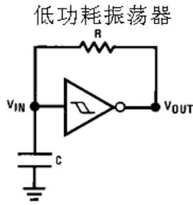
$$t_1 \approx RC \ln \frac{V_{T+}}{V_{T-}}$$
